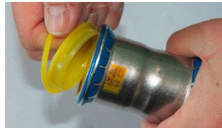
Bild 15: Entfernen der Schutzkappe und Prüfen des Dichtrings
