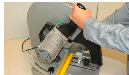
Bild 5: Ablängen mit mechanischer Säge mit Elektromotor
