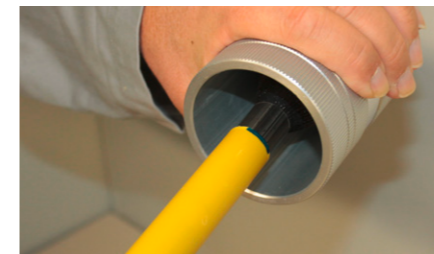
Bild 11: Innenentgraten mit Handentgrater
