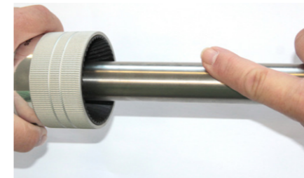
Bild 12: Außenentgraten mit Handentgrater
