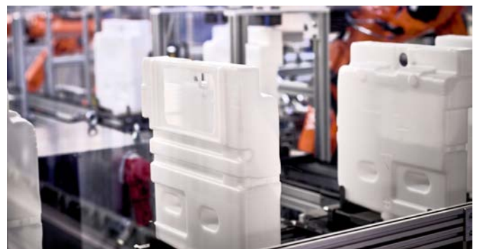
→ Die UP-Spülkästen aus Polyethylen werden aus einem Stück geblasen.
