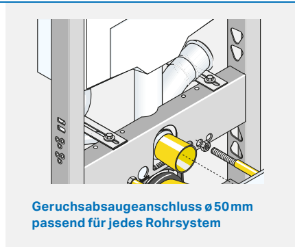
Schnellmontage-Rohrschelle mit Schallentkoppelung in zwei Positionen montierbar.
