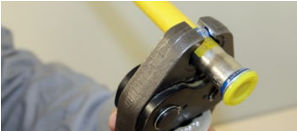
Bild 18: Pressvorgang mit Pressbacke d_a 12 – 35 mm
