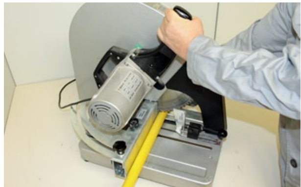
Bild 5: Ablängen mit mechanischer Säge mit Elektromotor
