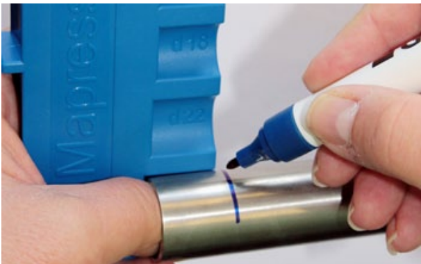
Bild 14: Markieren der Einschubtiefe mit Einschubtiefenlehre
