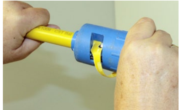
Bild 10: Abmanteln des Kunststoffmantels auf Einschubtiefe
