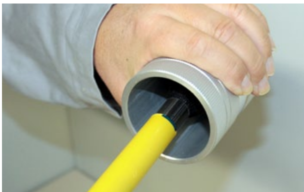
Bild 11: Innenentgraten mit Handentgrater
